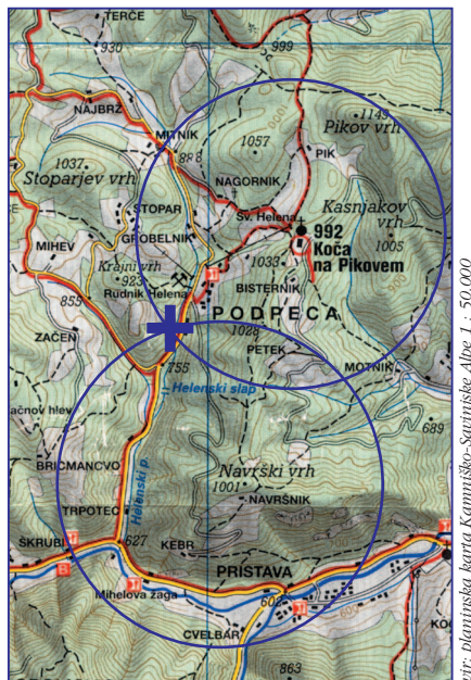
Slika 5.2.16: Določanje stojišča z razdaljami od znanih točk.
